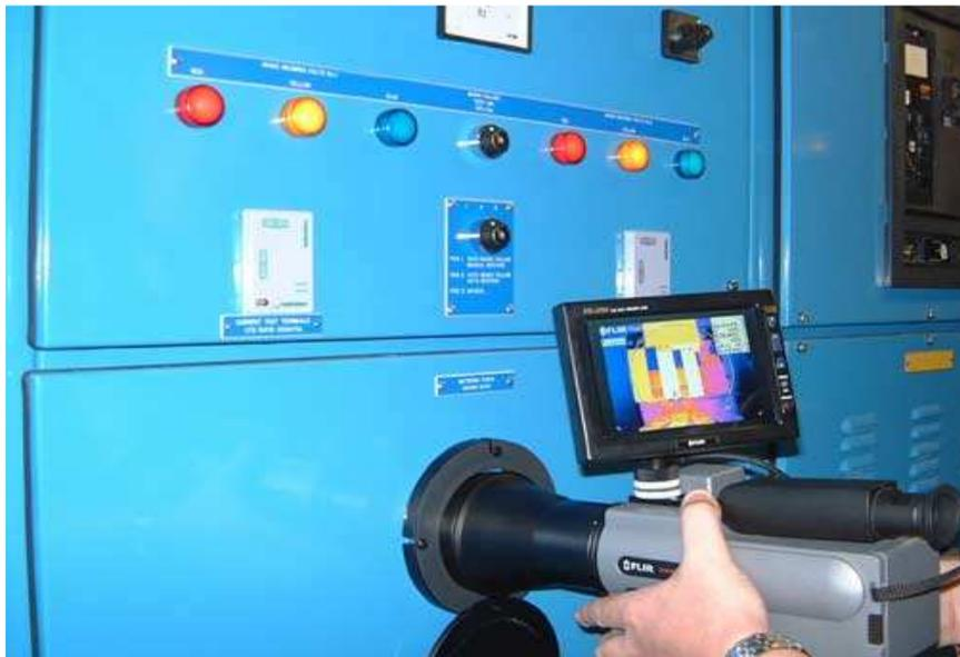
Figura 1: Ensaio de termografia convencional.
